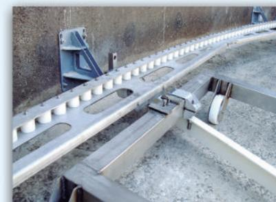
El anillo de rodadura se desliza encima de unas guías soporte autoajustables.
